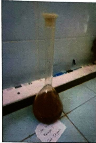
Gambar 4. Aparatus Pemeriksaan Zat Organik pada Agregat Halus.
