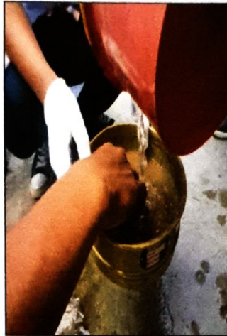
Gambar 3. Aparatus Pemeriksaan Bahan Lolos Saringan No. 200
