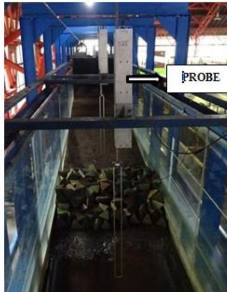
Gambar 14. Probe (Pengukur Elevasi Muka Air (Gelombang)) Sumber: Nurisman, N (2016)
